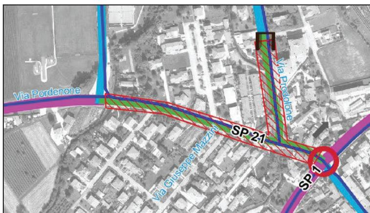
Fig. 2 – Proposta esemplificativa che indica la necessità di sviluppare un progetto di mitigazione della velocità e gestione di tratti di strade principali in modalità di condivisione: il caso di via Prodolone e della S.P. 21
