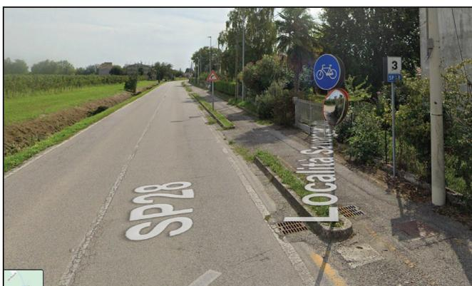
Fig. 78 – Tratto in prossimità del confine comunale: si evince l'insufficiente dimensione trasversale della pista ciclabile (estratto da Google maps)
