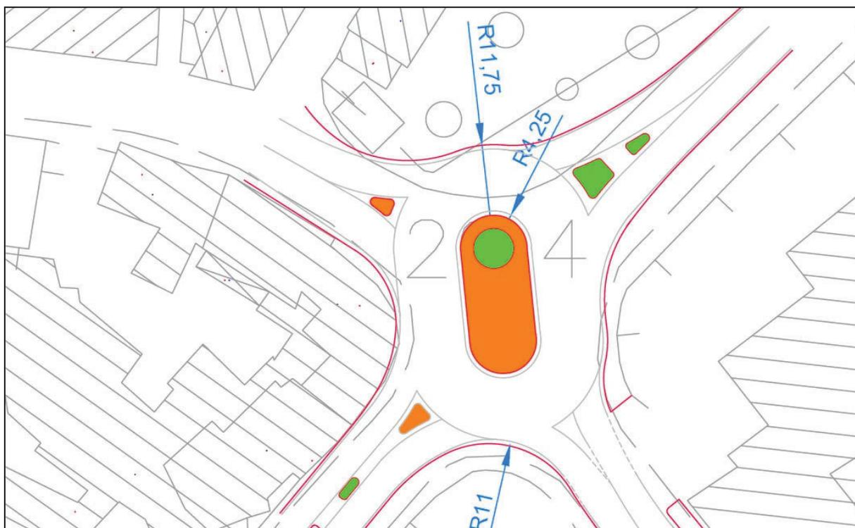
Fig. 8 – Schema funzionale proposto per la ristrutturazione della rotatoria tra la S.P. 21, la S.P. 28 e la S.P. 1, finalizzata ad incrementare la deviazione d'asse soprattutto nella direzione lungo la S.P. 1
