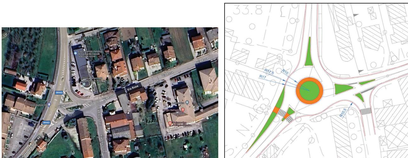
Fig. 69 – Intersezione tra via Rosa e la S.R. 463 (estratto da Google maps) e schema funzionale di ristrutturazione del nodo (attualmente in realizzazione)
