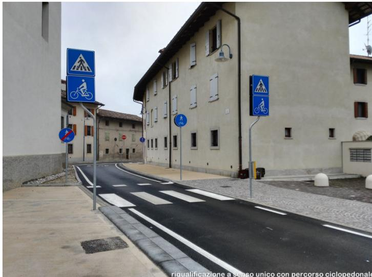
Fig. 12c – Soluzione con percorso ciclopedonale da un lato e marciapiede dall’altro nella zona di cambio lato e attraversamento segnalato per le due categorie; l’impiego di materiali differenti nella pavimentazione, oltre ad avere una ragione funzionale, produce anche il risultato di comunicare agli utenti le specifiche destinazioni degli spazi
