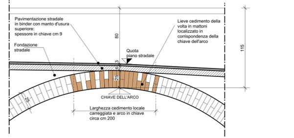
PARTICOLARE N.1: dettaglio del ponte in chiave con evidenza del cedimento locale SCALA 1/20
