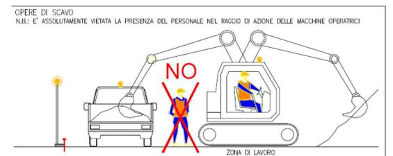
**ATTENZIONE:** durante le fasi di scavo e carico del materiale di risulta su autocarri è vietata la presenza del personale entro il raggio di azione delle macchine operatrici
